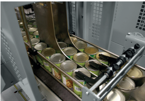
Verteiler im Einlauf
