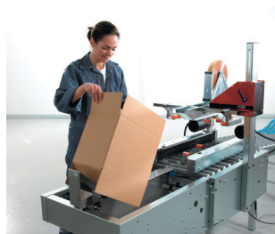
Die vordere und die hintere Klappe werden in Richtung Schiene gefaltet.
