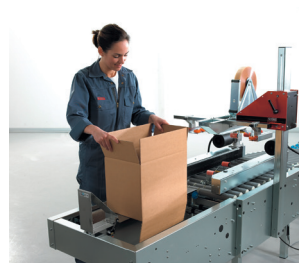
Der Karton wird zur Schiene geführt und anschließend werden die Seitenklappen auf der Unterseite gefaltet.
