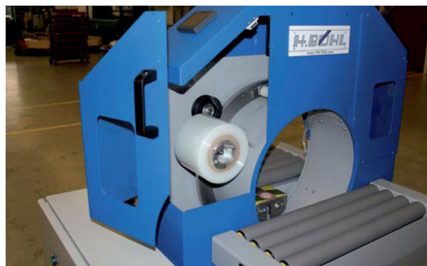
Schnellwechsellvorrichtung für Packmaterialrollen
